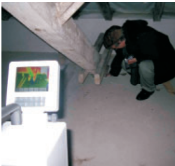
Qualitätssicherung hinsichtlich Wärmebrücken und Luftdichtheit.
