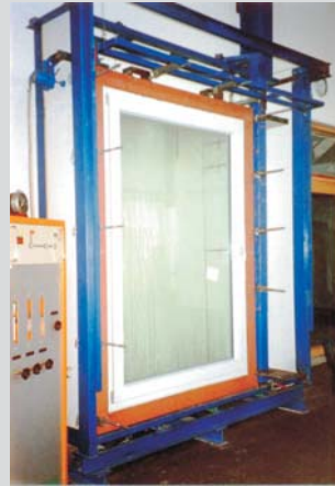
Prüfung der Schlagregendichtheit nach DIN EN 1027 mit Prüfdruckdifferenz bis 1950 Pa Klassifizierung: nach EN 12208: Klasse E 1800 A-Klassen-Norm-Obergrenze: Klasse 9A (600 Pa)
