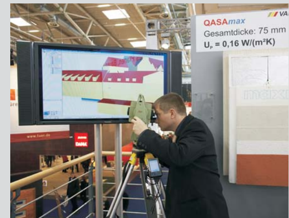
VARIOTEC Vermessungsservice per laser-tachymetrischem Aufmaß bis 180 \text{ m} \pm 2 \text{ mm}
