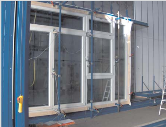
ITT Fensterwand geprüft nach DIN EN 14351-1:2006 mit folgenden Merkmalen: Windlast, Schlagregendichtheit, Dauerfunktion, Luftdurchlässigkeit, statische Verwindung, Statik-Berechnung U_f und U_w .
