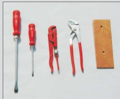
WK2 Prüfwerkzeuge Widerstandszeit: 3 min. Max. Gesamtprüfzeit: 15 min.
