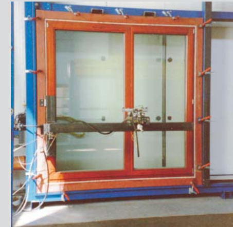
Prüfung der Dauerfunktion nach DIN EN 1191 Klassifizierung: nach DIN EN 12400 mit 20.000 Öffnungs- und Schließzyklen: Klasse 3
