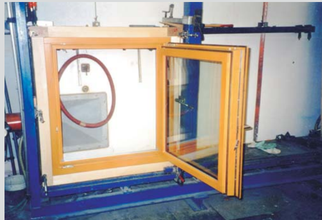
Prüfung der Luftdurchlässigkeit nach DIN EN 1026 bis 1000 Pa (Orkanstärke ca. 400 Pa) Klassifizierung: nach DIN EN 12207 Klasse 4
