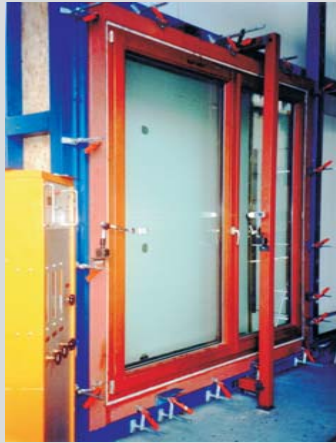
Prüfung der Widerstandsfähigkeit bei Windlast DIN EN 12211 Klassifizierung: nach DIN EN 12210 Klasse C5
